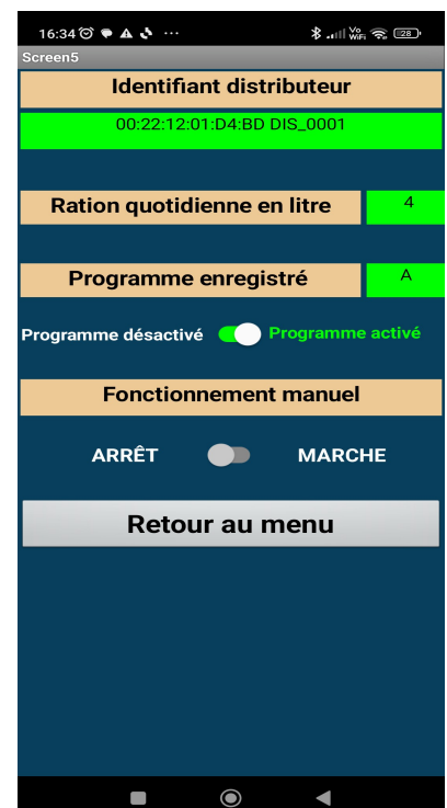
Écran indiquant l'identifiant du doseur, la ration quotidienne et le programme A enregistré et activé
