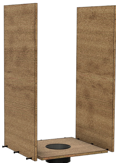
1. Assemblage des 2 faces latérales sur le fond du réservoir avec 6 vis de 25mm
