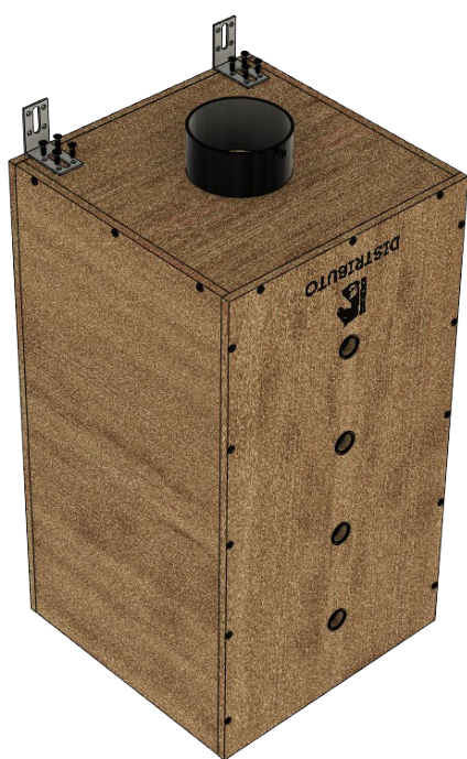
3. Assemblage des 2 équerres de fixation sur le fond du réservoir avec 8 vis de 15mm (trous pré-perçés)
