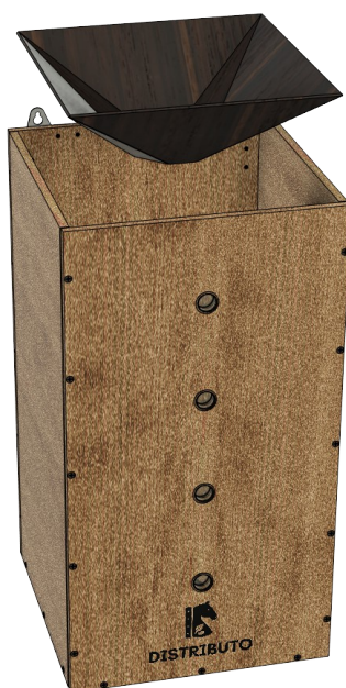
5. Introduction de l'entonnoir jusqu'au fond du réservoir
