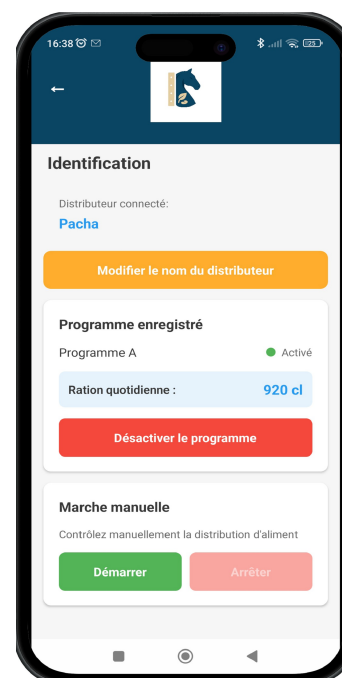
Écran indiquant l'identifiant du doseur, la ration quotidienne et le programme A enregistré et activé
